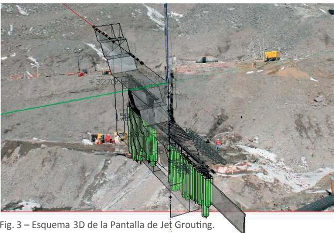
Fig. 3 – Esquema 3D de la Pantalla de Jet Grouting.
