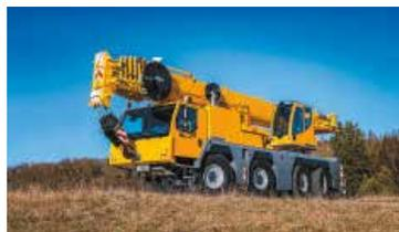
La nueva grúa lleva 8,8 toneladas de contrapeso con una carga por eje de 12 toneladas, lo que supone un aumento de 2,1 toneladas en comparación con el modelo precedente. Con esta configuración, la LTM 1090-4.2 es actualmente la grúa de 4 ejes más potente del mercado. Con ECOdrive y ECOMode, la nueva grúa de 90 toneladas funcionará de una forma especialmente ecológica y con un bajo nivel de ruido y consumo. **M**
