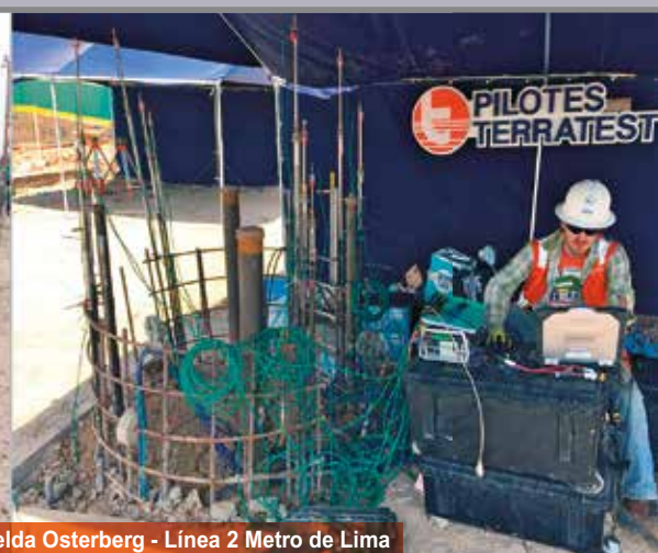
Ensayo de Compresión Axial con Celda Osterberg - Línea 2 Metro de Lima
