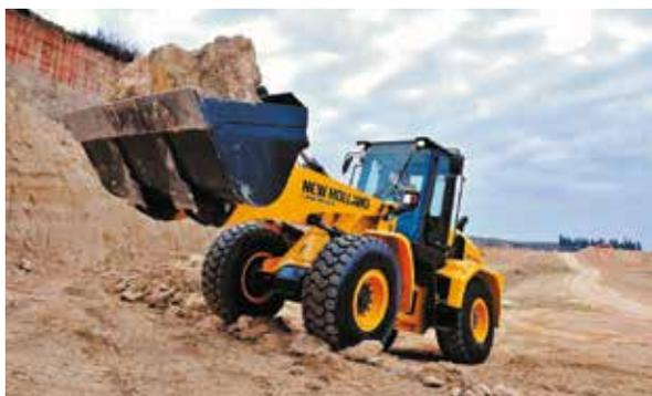
Tiene una nueva cabina que cuenta con la Función Ride Control (LTS) la cual es utilizada para amortiguar las vibraciones provenientes de las irregularidades del terreno, evitando generar golpes en el brazo de la máquina, al cargar el material en el desplazamiento, evitando pérdida de carga. Asiento ergonómico ajustable y termoregular, nuevo sistema de calefacción y aire acondicionado, sistema de sonido de tecnología de punta, perfecta visibilidad en la ventana delantera y trasera.
