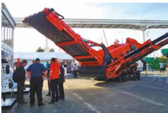
La Sandvik QE441 Free Flow es una solución versátil y eficiente para el procesamiento de materiales difíciles de cribar y productos con alto contenido de humedad.
