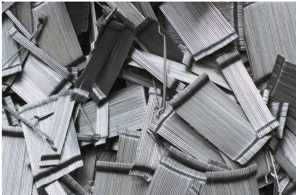
A su turno, el ing. Juan Manuel Alvarado, gerente de ventas Dramix® minería de Prodac-Bekaert., explicó que las fibras de acero son usadas para dotar de capacidad de carga post fisura (luego de la falla del concreto) en flexión. Su buen comportamiento frente a este tipo de esfuerzos, le permite reemplazar parcial o totalmente el refuerzo convencional de barras de acero o mallas soldadas, en algunas aplicaciones.
