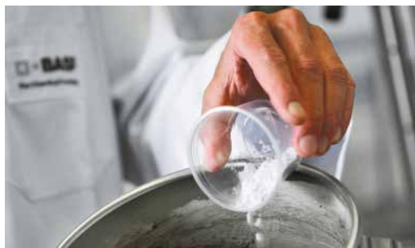
Fibras sintéticas con tratamiento químico superficial, que mejora la adherencia al concreto.
